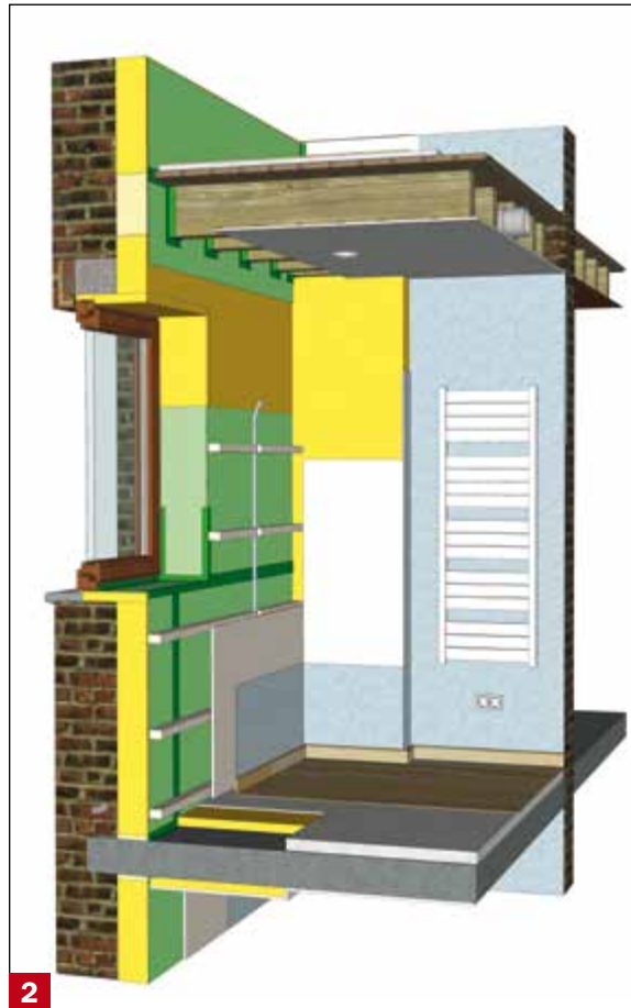
2 Mogelijke situatie na het aanbrengen van binnenisolatie, volgens standaard aansluitingsdetails (isolatie- (geel) en luchtdichte laag (groen) schematisch weergegeven, basisprincipes geldig voor alle binnenisolatiesystemen; delen weggelaten voor een betere visualisatie van de aansluitingen)
