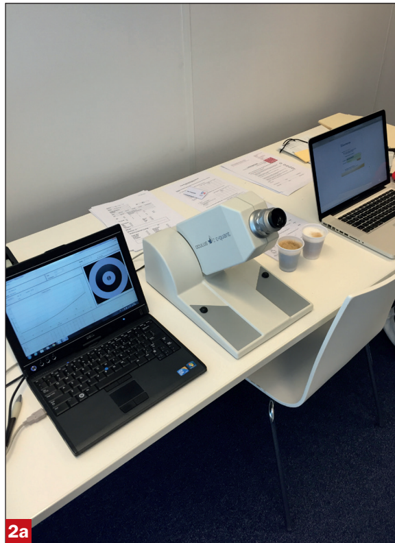
C-quant (meten en beoordeling van ervaren strooilicht) en topsterkte meter (bepaling sterkte brillenglazen)
