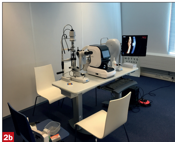
Van links naar rechts: biomicroscop, beoordeling gezondheid van het oog, autorefractormeter, grove bepaling van de benodigde sterkte van het oog en keratograaf, beoordeling van kromming van het oog, optische kwaliteit en kwaliteit van de traanfilm
