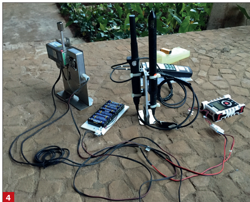
4 Meting op de universiteit van São Paulo, van links naar rechts: fijnstofmeter, CO 2 -/RV-/temperatuur-/luchtsnelheid-meter en datalogger
