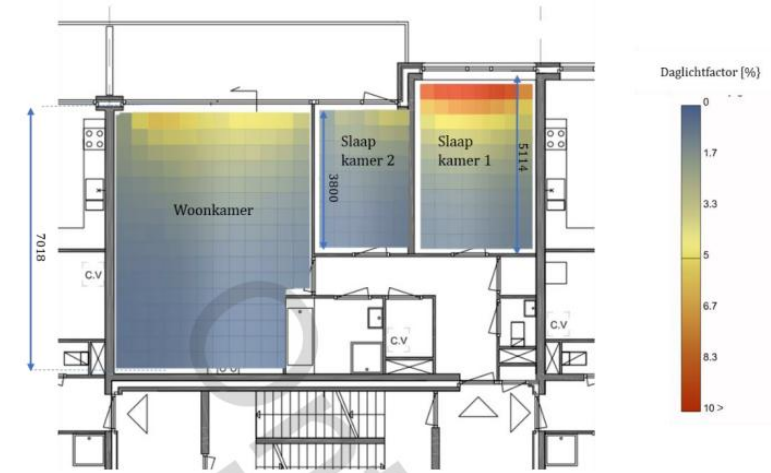
Figuur 29 — Voorbeeld daglichtfactoren tussenappartement
