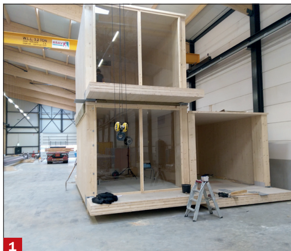
Houtkern-modules (Circlewood) in verticale (links) en horizontale opstelling (rechts) - 1 e geluidmetingen (2021)
