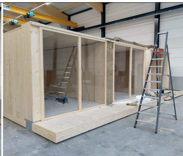
Houtkern-modules (Circlewood) in verticale (links) en horizontale opstelling (rechts) - 1 e geluidmetingen (2021)
