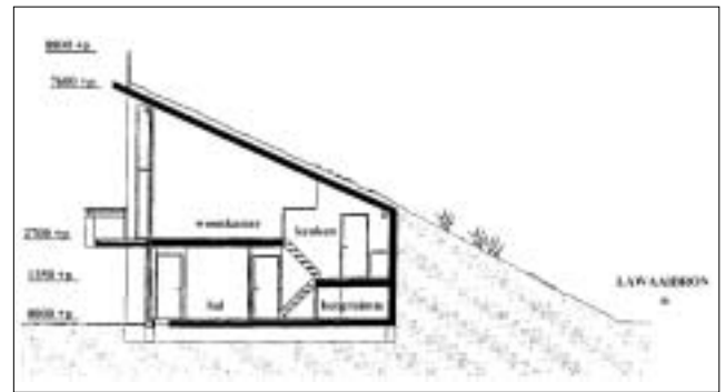
FIGUUR 4: DWARSDOORSNEDEN OVER EEN GELUIDWAL-WONING
